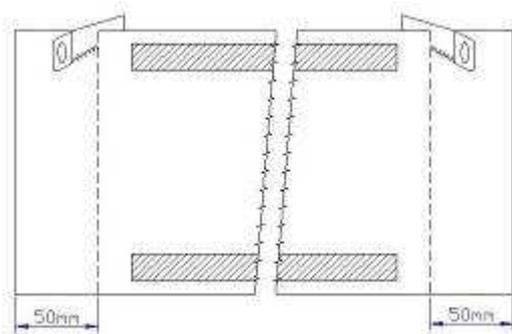
Les ronds d'acier sont complètement moulés dans le plastique. L'acier ne peut donc pas être affecté et la corrosion est ainsi évitée. 5 cm peuvent être coupé à chaque extrémité.
